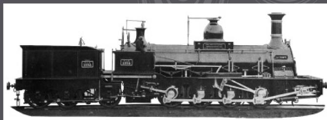
La Rampe (1859), locomotive destinée au «Lombard-vénitien» en Italie. Les 4 essieux moteurs sont maintenus parallèles grâce à un jeu latéral obtenu par des groupes de balanciers de suspension: un système encore utilisé sur des machines allemandes dans les années 1950.
